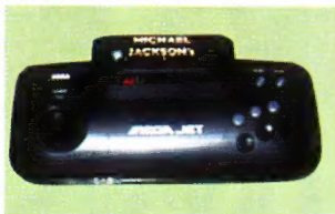
↑与JAL航空合作的新机种，用的同样是MD的卡带。机身只有按键和卡带插槽，要玩游戏的话得插上飞机座位内的小屏幕才行。
